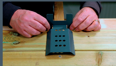
6. Vänd Deck Mate™ upp och ner och placera den så att skarven är mitt under den mittersta hålraden
